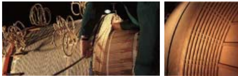
El uso de cable traspuesto pegado con epoxy y la utilización de conductos de refrigeración axial incrementa la resistencia a los cortocircuitos
