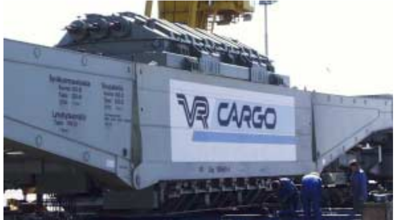
Transformador proyectado para transporte especial por ferrocarril
