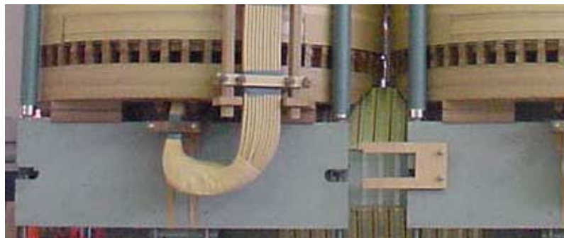
Detalle del sistema de apriete independiente de una bobina
