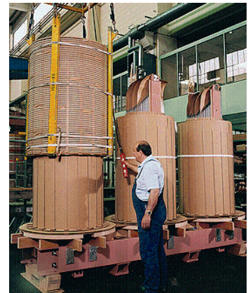
Montaje de transformador de potencia media
