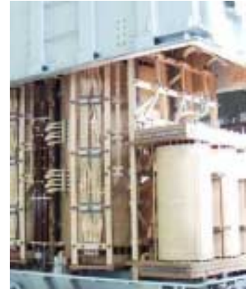
Assemblage d'un transformateur de grande puissance
