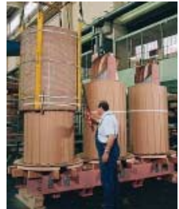
Assemblage d'un transformateur de moyenne puissance
