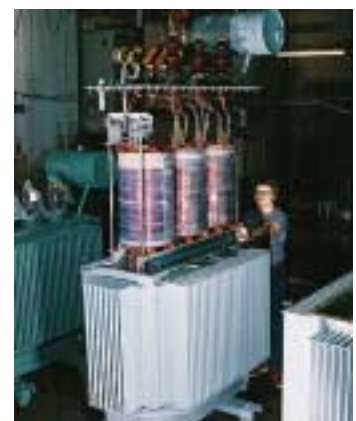
Mise en cuve d'un transformateur de distribution
