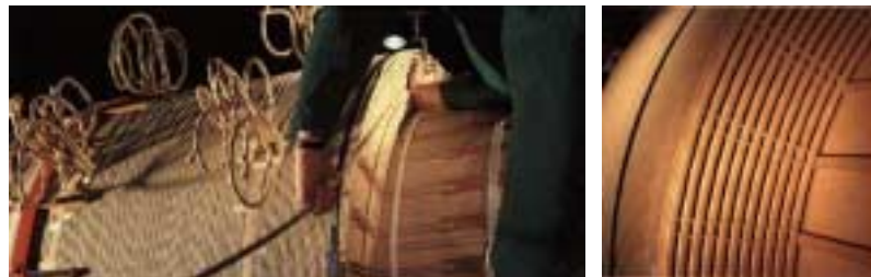
Die Verwendung von harzbeschichteten Drilleitern erhöht die Kurzschlussfestigkeit
