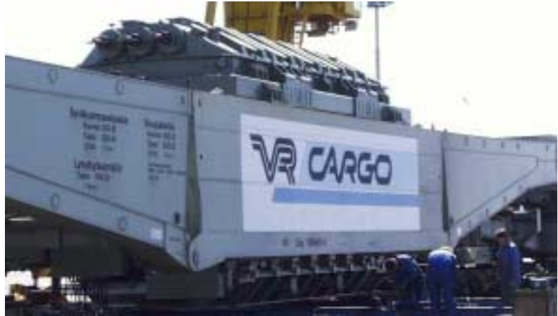
Transformateur conçu pour transport spécial par voie ferrée
