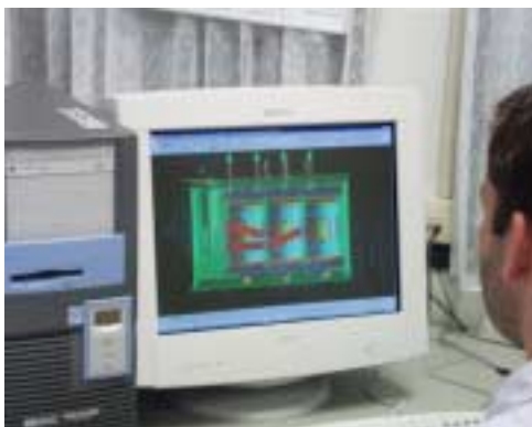
Vue 3D de la partie active d'un transformateur 150 MVA / 220 kV
