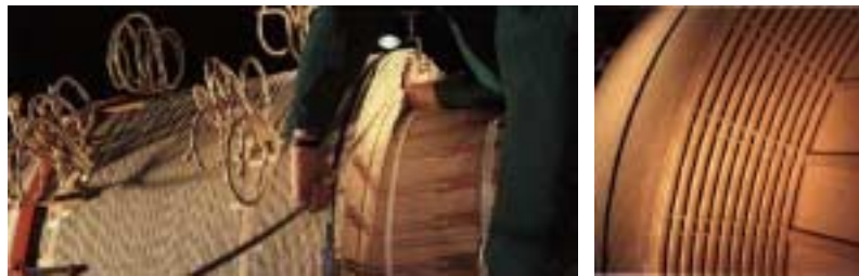
L'utilisation d'un câble transposé époxyde limité et l'application de canaux de refroidissement axial augmente la tenue au court-circuit
